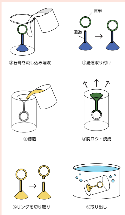
指輪の製造工程。①～③の緑の部分でワックスを使用
