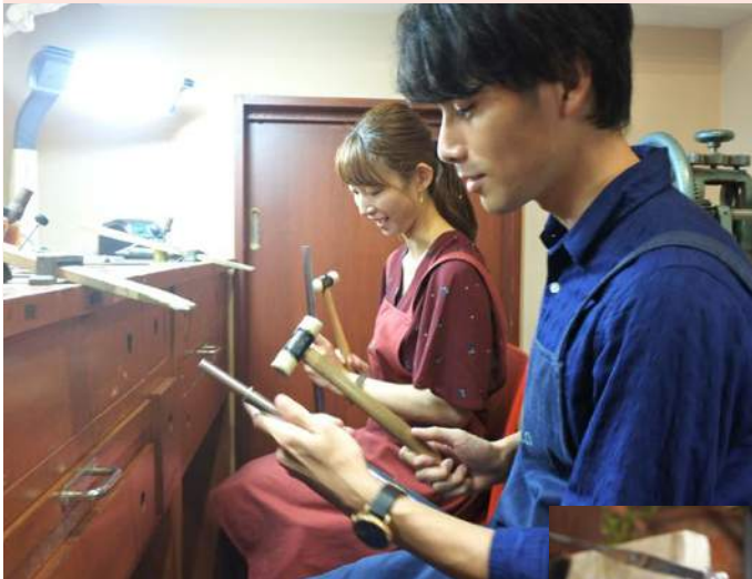
おそろいのエプロンを着けて、リングを真円にする作業中
