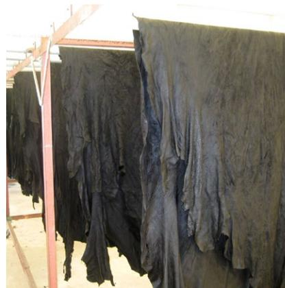
乾燥するための専用室で時間をかけて革を乾かす
